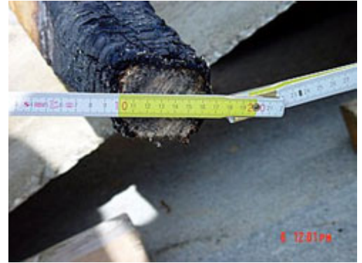
Der verbliebene Querschnitt wird ermittelt.
