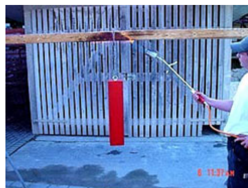
Ablauf des Brandversuches: Beflammen des Tragbalkens.
