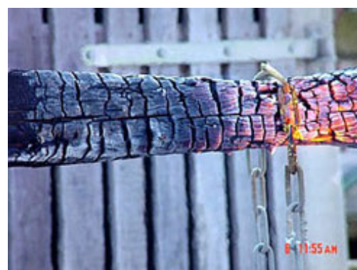
Versagen der Tragfähigkeit steht kurz bevor.
